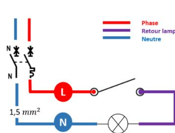
Interrupteur va et vient
